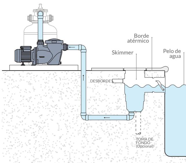
La electrobomba puede ser instalada sobre el nivel de suelo ya que **posee excelente capacidad de autocebado**. En este caso debe ser montada sobre una base sólida y firme en posición horizontal a un mínimo de 5cm del suelo y a un mínimo de 10cm de la pared con respecto a la tapa del ventilador, para evitar los efectos corrosivos de la humedad o derrames ocasionales de agua en el lugar emplazado.
