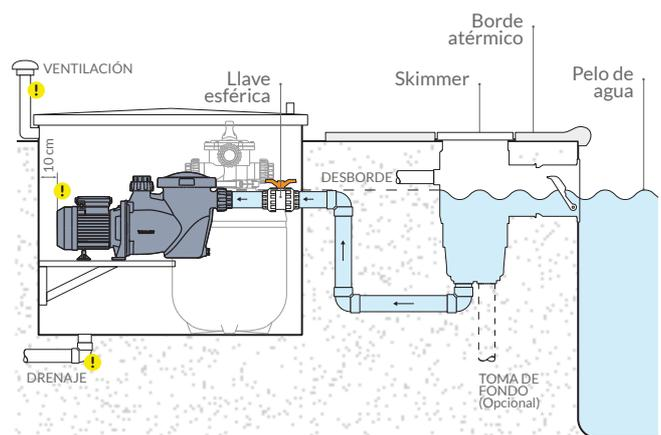
**ⓘ** ATENCIÓN: Para el cuidado y el buen funcionamiento de la bomba, es importante realizar una correcta instalación, teniendo en cuenta:
