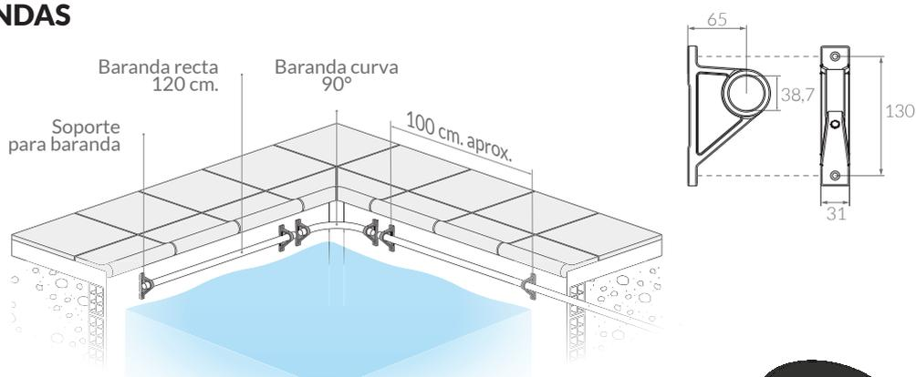
**IMPORTANTE:** Sugerimos colocar un soporte por cada metro de baranda utilizando tacos plásticos  $\varnothing$ 8mm y tornillos de acero inoxidable.
